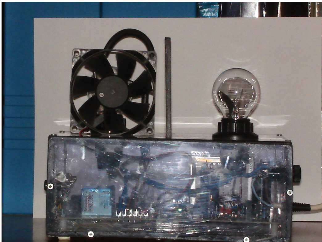
Fig. 5 Foto degli apparati di acquisizione e controllo della temperatura e luminosità.
