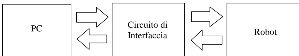
Fig. 1 schema a blocchi del controllo del braccio meccanico
