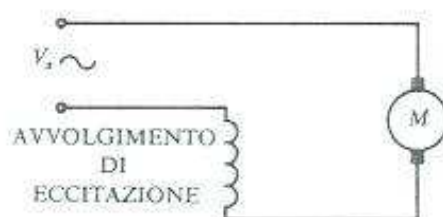
Fig. 6 Schema elettrico di un motore universale
