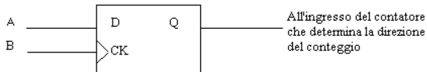
Figura 6. Circuito per discriminare il senso di rotazione dell'asse rotante
