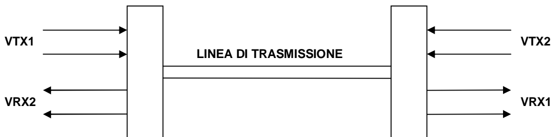
Fig. 1 Schema semplificato di un collegamento con forchetta telefonica.
